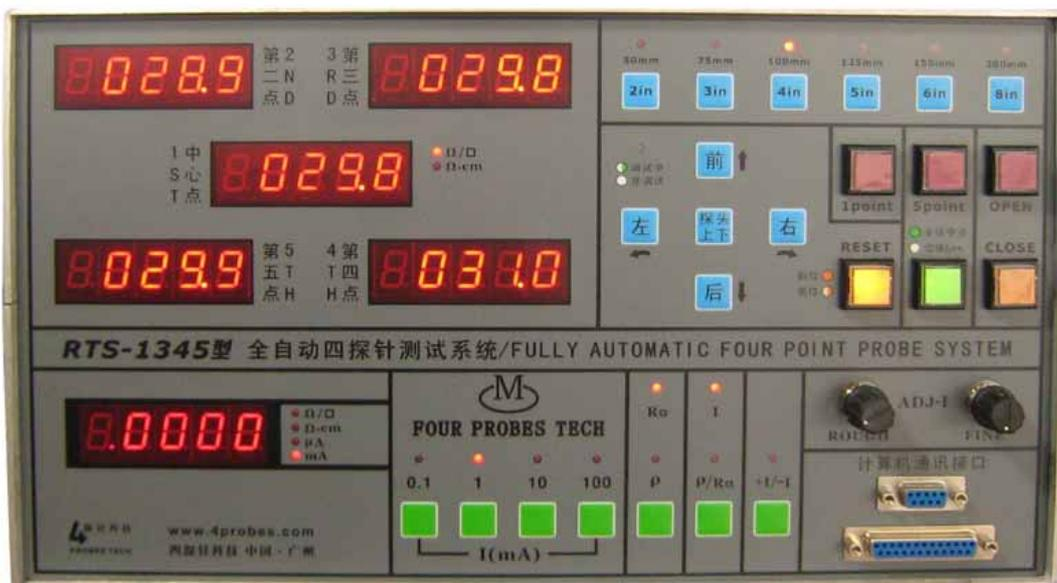
RTS-1345 型全自动四探针测试系统是运用四探针测量原理的多用途综合全自动测量设备。该仪器按照单晶硅物理测试方法国家标准并参考美国 A.S.T.M 标准而设计的，专用于测试半导体材料电阻率及方块电阻(薄层电阻)的专用仪器。
