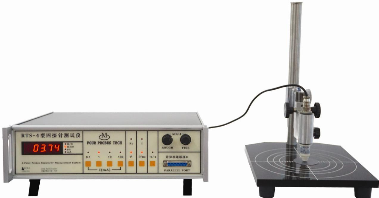
**RTS-4 型四探针测试仪**是运用四探针测量原理的多用途综合测量设备。该仪器按照单晶硅物理测试方法国家标准并参考美国 A. S. T. M 标准而设计的，专用于测试半导体材料电阻率及方块电阻(薄层电阻)的专用仪器。
