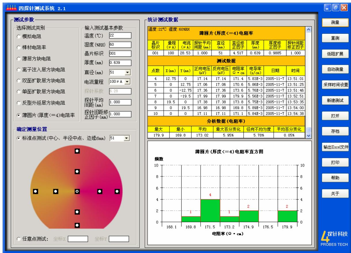
RTS-4 型四探针软件测试系统是一个运行在计算机上拥有友好测试界面的用户程序, 通过此测试程序辅助使用户简便地进行各项测试及获得测试数据并对测试数据进行统计分析。
