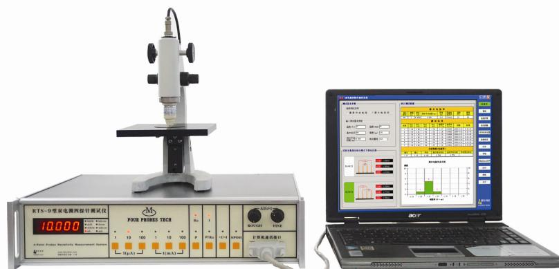
**RTS-9 型双电测四探针测试仪**采用了四探针双电测组合(亦称双位组合)测量新技术,将范德堡测量方法推广应用到直线四探针上,利用电流探针、电压探针的变换,在计算机控制下进行两次电测量,把采集到的数据在计算机中加与分析,能自动消除样品几何尺寸、边界效应以及探针不等距和机械游移等因素对测量结果的影响。因而每次测量不必知道探针间距、样品尺寸及探针在样品表面上的位置。由于每次测量都是对几何因素的影响进行动态的自动修正,因此显著降低了几何因素影响,从而提高了测量结果的准确度。所有这些,用目前大量使用的常规四探针测量方法所生产的仪器是无法实现的。
