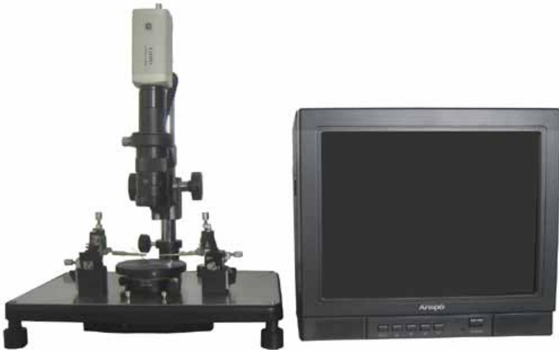
ST-102B 型探针测试台与测试仪器配接后可用于集成电路芯片及各种晶体管芯的电参数测试及功能调试，适用于科研、新品试制及小批量生产的中间测试。
